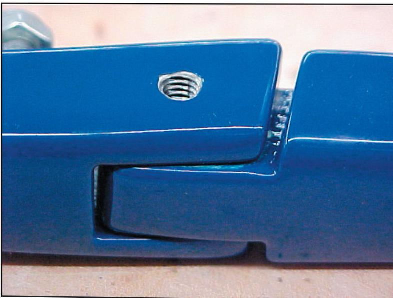
Das Scharnier kann danach ggf. grundiert und lackiert werden. Das Gewinde sollte vor der Lackierung mit einem Stückchen Schaumstoff ausgefüllt werden, welches später mit einer Nadel oder Pinzette wieder herausgezogen wird. Das Bild zeigt ein fertig lackiertes Scharnier von der Unterseite her. (Bild links)
